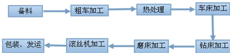
图4-6 螺栓生产工艺流程图
