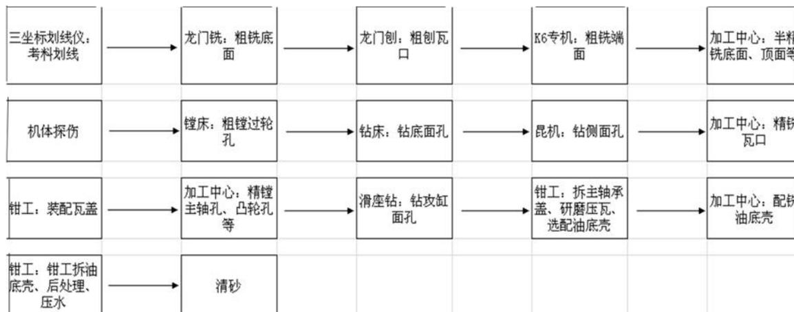
图4-3 机体加工生产工艺流程图
