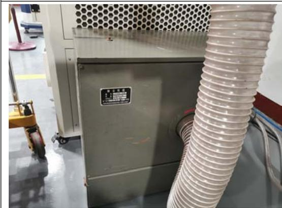
激光焊机焊烟净化器
