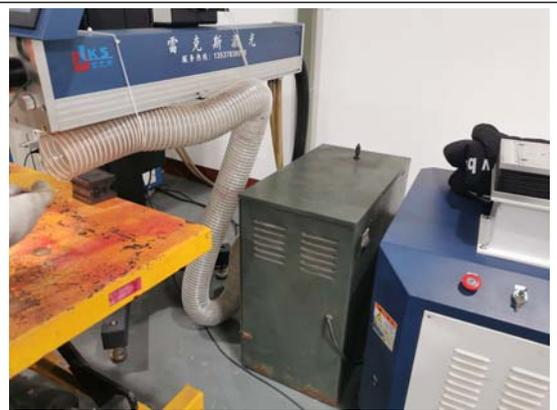
激光焊机焊烟净化器
