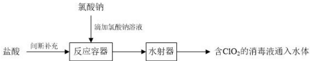
图 2-3 二氧化氯反应流程图
