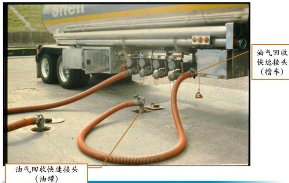
图 2-3 一次油气回收实例图
